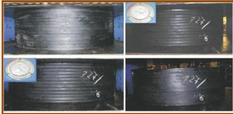
Fases correspondientes a un ensayo de rutina de rigidez a compresión realizado en nuestras instalaciones.
